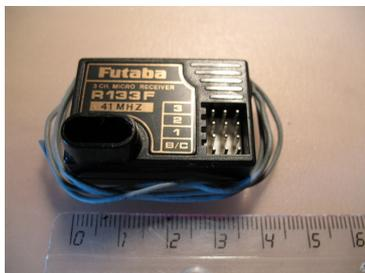
Il accueille un quartz de réception (R.X) calé sur la même fréquence que sur le quartz de la radio (T.X).
