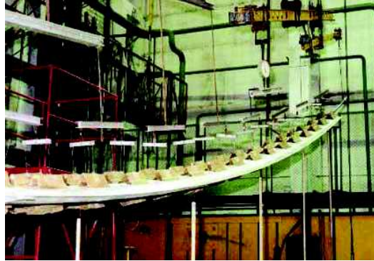
Test de flexion d'une aile en statique.
