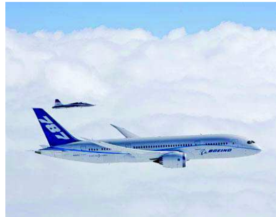
Flexion surprenante d'une aile de 787. Et pour les planeurs de compétition c'est pire.
