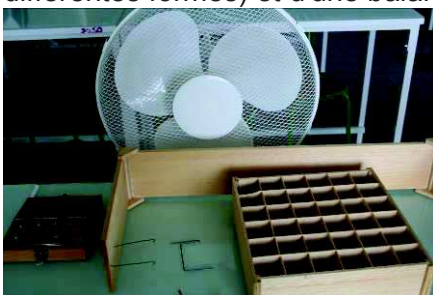
Tranquillisateur, "soufflerie", support et matériel de mesure
