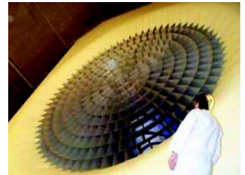
Grille (ou filtre) réalisant un écoulement laminaire.
