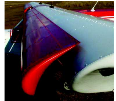
Bec d'un petit avion (CH 701) "STOL"
