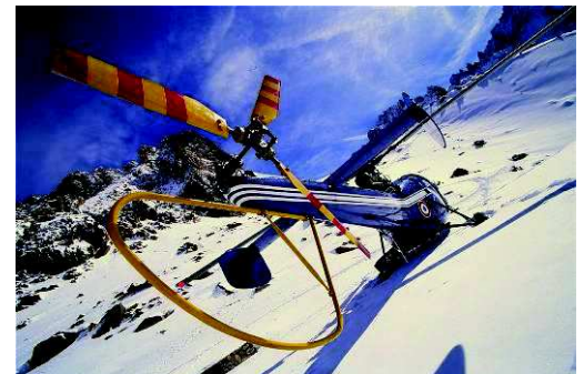
Rotor anti-couple classique (Alouette III)
