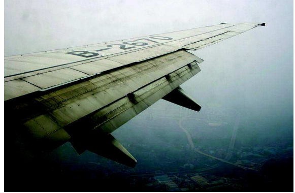
Volets fowlers 3 sections (avec fentes)
