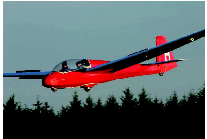
Planeur ancien : K 13 ⇑ (aérofreins d'extrados ET d'intrados)
