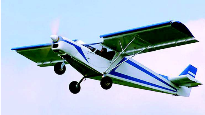
ULM STOL avec becs et volets à fente
