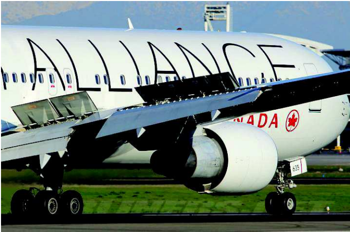
Boeing 767 Spoilers ouverts ⤴ et schéma de contrôle ⤵
