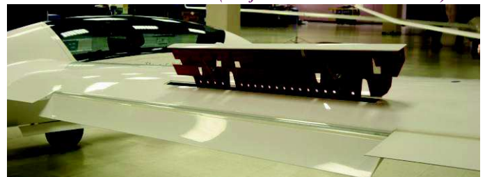
Planeur ancien : K 13 ⇑ (aérofreins d'extrados ET d'intrados)
