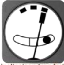
Inclinaison trop forte (glissade)
