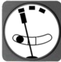
Inclinaison trop forte (glissade)
