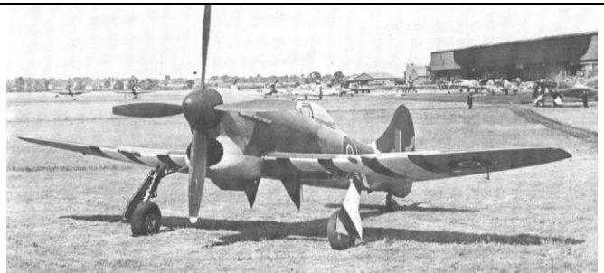
Avec le Hawker Tempest on passe à un avion plus lourd, plus grand, plus fin, plus puissant (noter la quadripale de plus grand diamètre) et avec un profil plus mince... pour augmenter la vitesse
