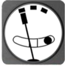
Inclinaison trop faible (dérapage)
