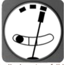
Inclinaison trop faible (dérapage)
