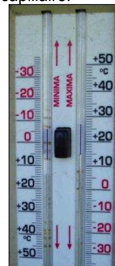
Thermomètre mini / maxi
