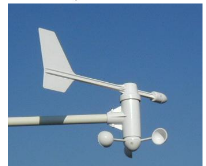
Girouette et anémomètre couplé.
