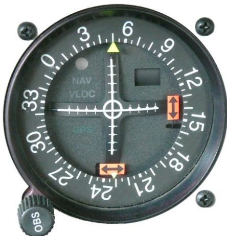
VOR et ici ILS ( VHF Omnidirectional Range ) ( Instrument Landing System )
